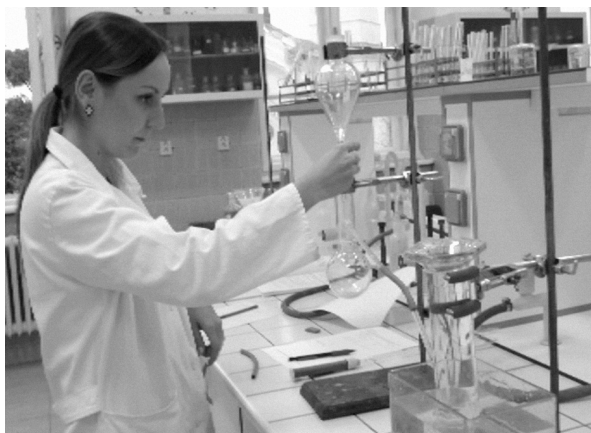
Obr. 2 Stanovenie množstva \text{CaCO}_3 z objemu \text{CO}_2
